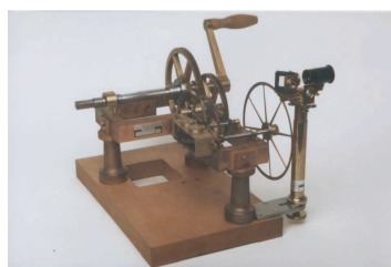
FIGURE 88 Montaje experimental de Fizeau para medir la velocidad de la luz (© AG Didaktik und Geschichte der Physik, Universität Oldenburg)
